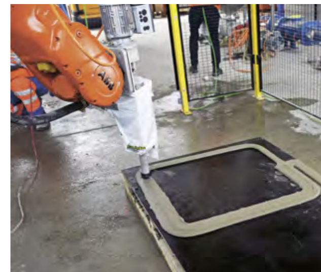
Der mit einer Spezialdüse ausgerüstete Industrieroboter stellt als 3D-Drucker erste einfache Betonobjekte her.
